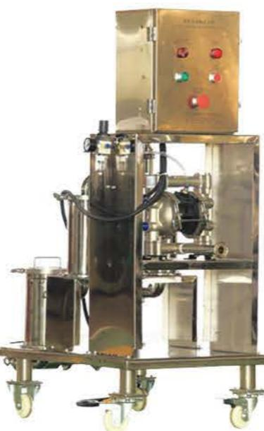
1. 双过滤通道配置(1套常用、1套备用),适用于浆料连续供料;两组过滤通道可自由切换;
